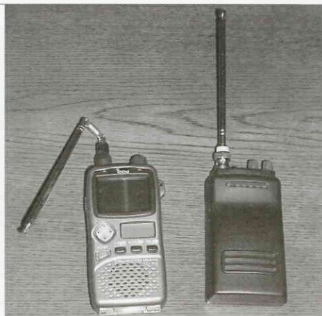
盗聴発見器。左は盗撮電波にも対応。右は自動的に盗聴電波を発見するタイプ
