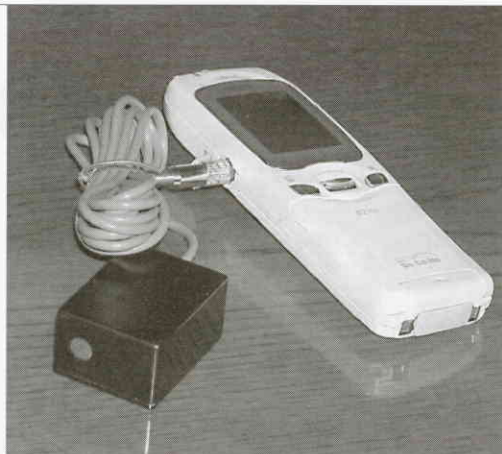
携帯電話につなぐだけの窃听器。このタイプの窃听器は普通の窃聴発見器では見つけられない
